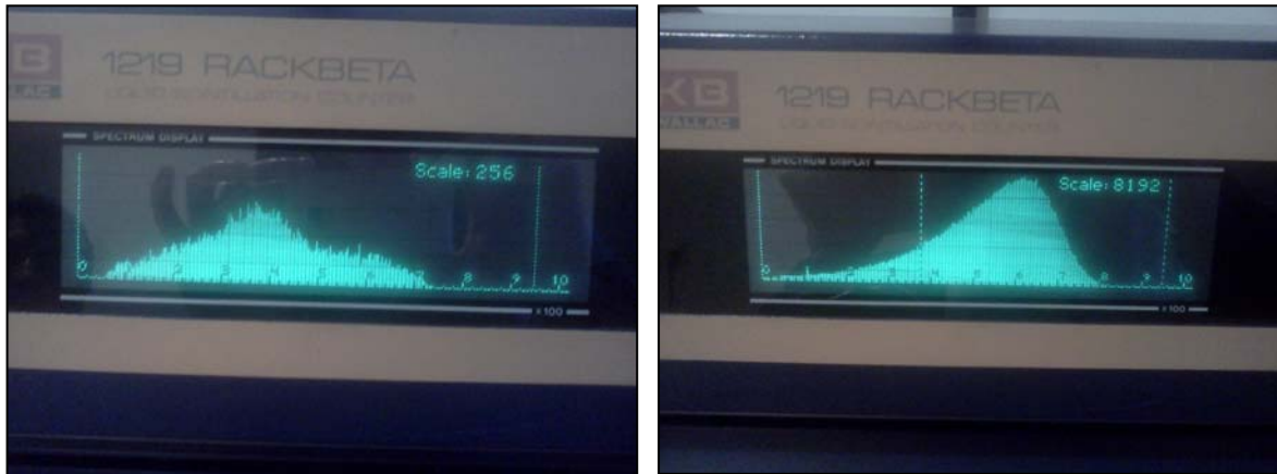
Слика 12. Снимак енергетског пика на течном сцинтилационом бројачу 1219 RACKBETA за ^{90}\text{Y} (лева фотографија) и ^{177}\text{Lu} (десна фотографија)
